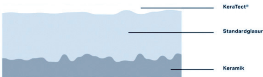
Abbildung 116: KeraTect® Spezialglasur, Vergleich der Oberflächenbeschaffenheit
