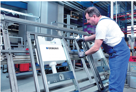
Abbildung 29: Montage der Sanitäreinheiten im Werk
