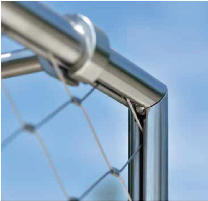
X-TEND CXS Edelstahlseilnetze bestehend aus Seil- $\varnothing$  1,5 mm und kraftschlüssig verpressten Klemmen in Maschenweiten von 40, 50 oder 60 mm werden in Rahmen aus Einfassprofilen innenliegend gefasst. Die geschlitzten Edelstahl-Einfassprofile sind in den Versionen Rundrohr  $\varnothing$  27 mm oder Rechteckprofil 30/20 mm erhältlich. Der spezielle Verschlussmechanismus in den Rahmen-Ecken ist nahezu unsichtbar.
