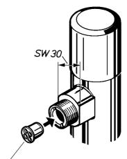
Verwenden bei Fließdruck > 5 bar oder beim Überspritzen am Toilettenbecken.
