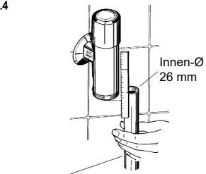
Das Spülrohr ca. 35 – 40 mm unterhalb des Spülergehäuses abschneiden.
