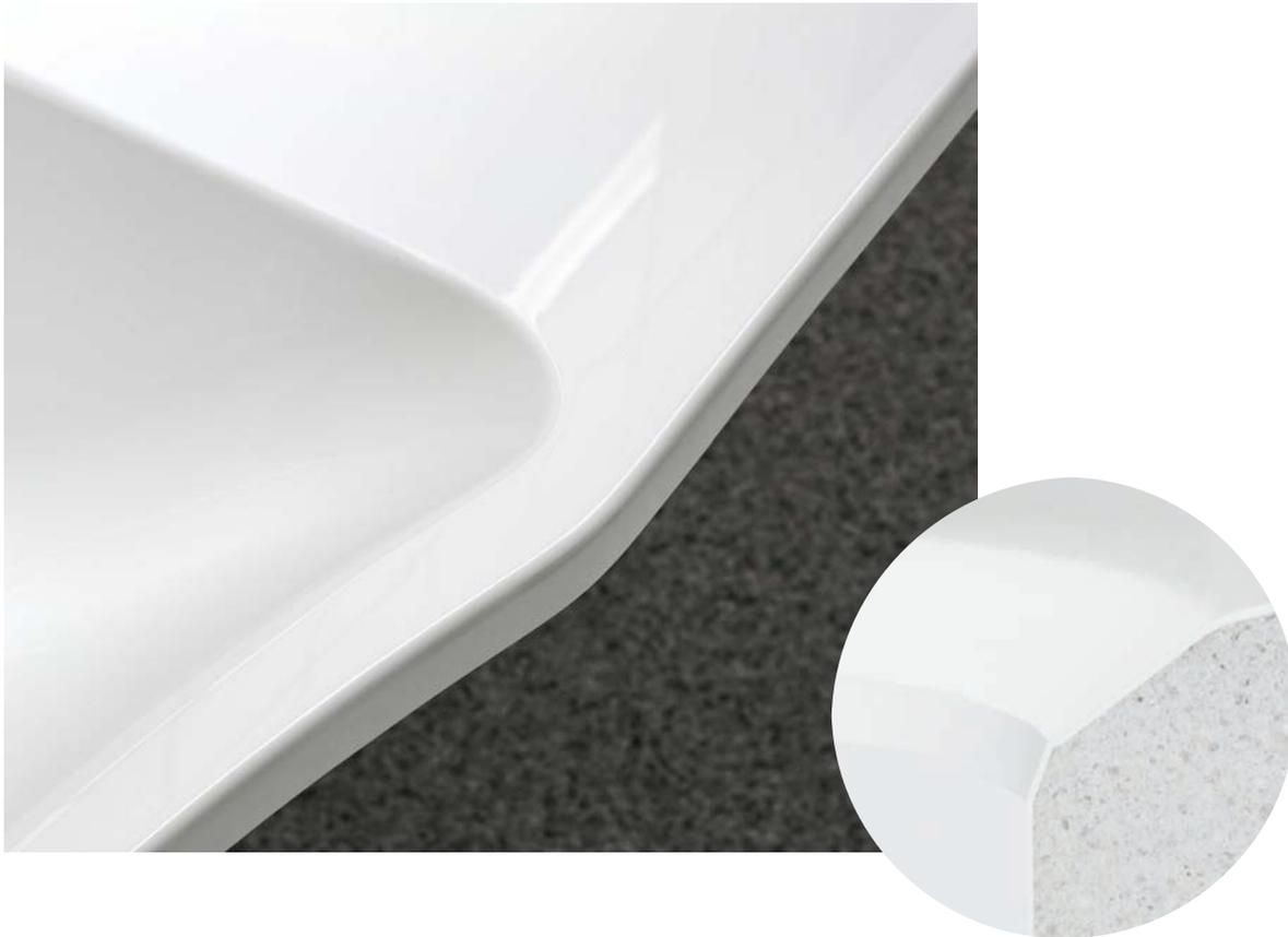
MIRANIT steht für die stabile Verbindung aus circa 80 % natürlichen Mineralien, wie Marmormehl, Sandstein und Quarzsand und circa 20 % eines hochwertigen ungesättigten Polyesterharzes. Aufgrund seiner hervorragenden Fließfähigkeit lässt sich der kunstharzgebundene Mineralwerkstoff auch in geringer Materialstärke in nahezu jede Form bringen.
