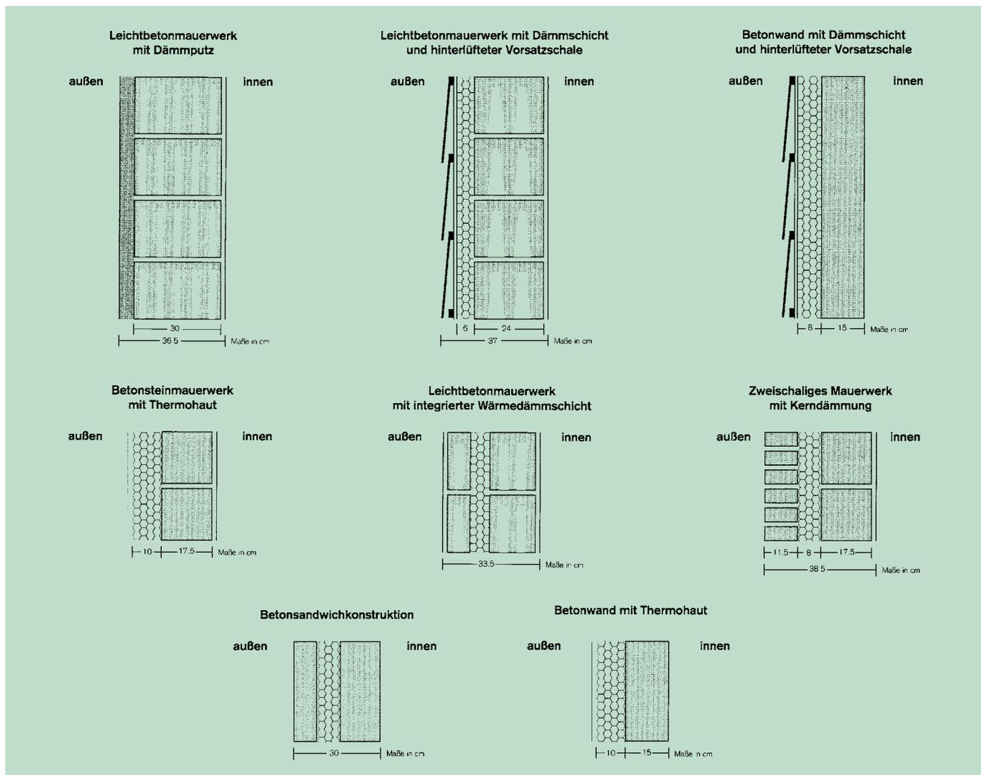
**Bild 2: Mehrlagige Außenwände (Beispiele); je nach Dicke der Wärmedämmschicht weisen diese Konstruktionen U-Werte zwischen  $0,25$   $W/(m^2 \cdot K)$  und  $0,5$   $W/(m^2 \cdot K)$  auf**
