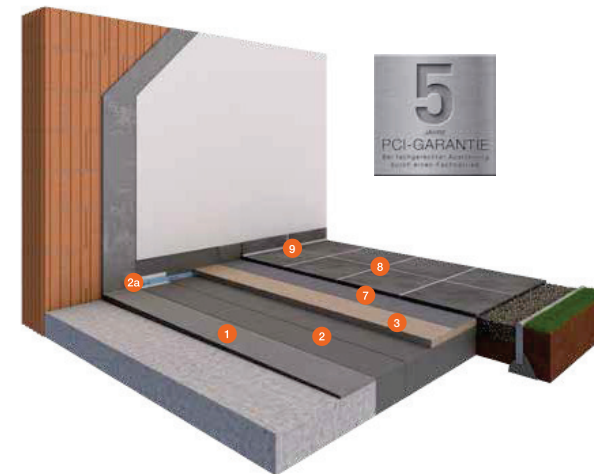
Drainmörtel PCI Epoxigrund 390 und PCI Quarzsand DM 1 bis 4 auftragen und über Lehren abziehen
