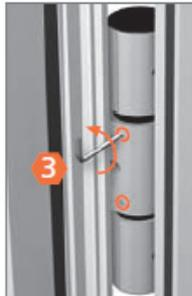
3 Gewindestifte mit einer 1/2-Umdrehung lösen.
