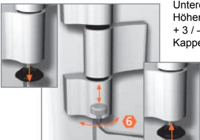
6 Untere Kappe entfernen. Höhenverstellung  $+ 3 / - 2$  mm. Kappe aufsetzen.
