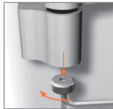
Hebespindel heraus - schrauben.
