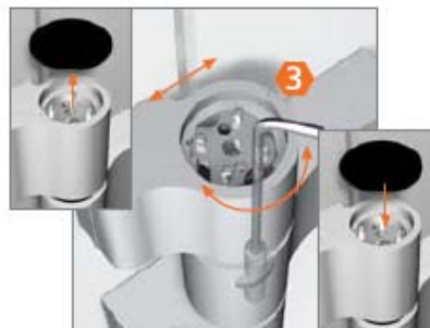
Kappe entfernen. Horizontalverstellung \pm 2,5 mm. Kappe aufstecken.
