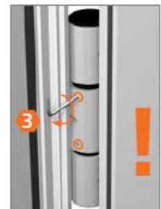
Wichtig: Gewindestifte abwechselnd festziehen.
