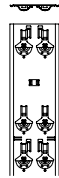
Artikel 625 Systemprofil blank* Werkstoff: AlMg3 H22 (EN AW-5754), unbeschichtet zur Montage mit Fugenprofil K20/8
