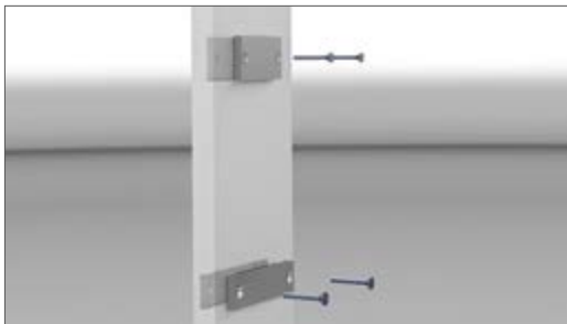
Grundplatte an Basis-Unterkonstruktion befestigen
