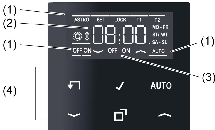
Bild 1: Display und Bedienfläche
