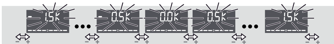
Bild 16: Einstellen der Sollwertverschiebung
