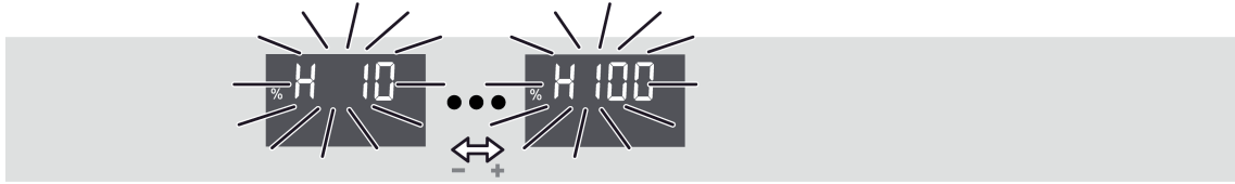
Bild 24: Einstellung der Display-Helligkeit
