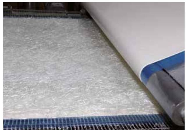
Einbringung der Glasfasern in das Rohmaterial.
