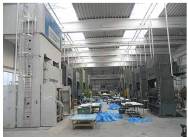
WOLFA-Fertigungslinien für GFK-Pressteile.
