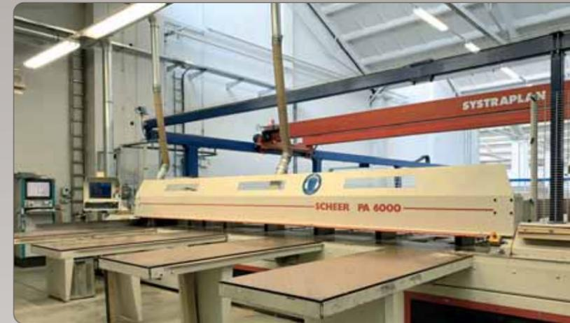
Mittels Portalkran werden die im Flächenlager gestapelten Verbundelemente der Säge zugeführt.
