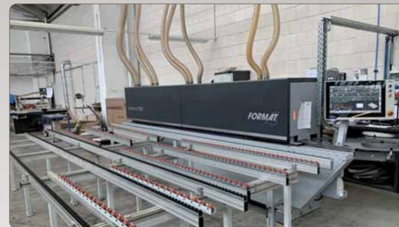
An dieser Anlage werden die Verbundelemente bekantet. Wahlweise mit PP-Kante oder Melaminkante.
