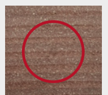
natürlicher Fasereinschluss nach mechanischer Behandlung
