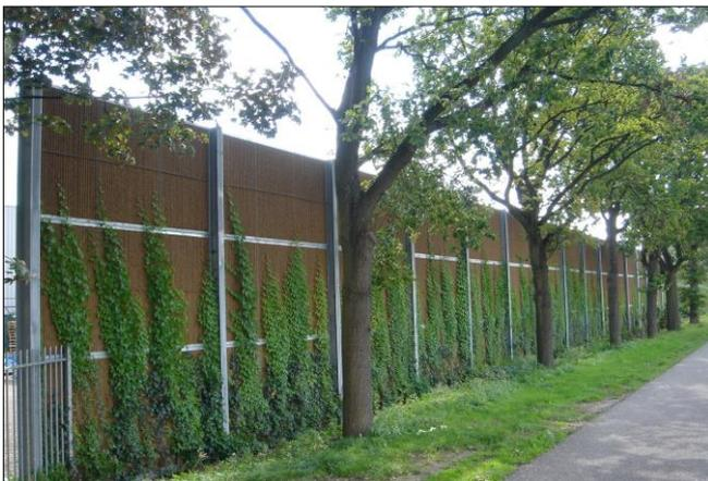
KOKO WALL ist eine leichtgewichtige Lärmschutzwand. Trotz der geringen Masse der Elemente (ca. 25 kg / m<sup>2</sup>) hat die Wand eine gute schalldämpfende und -dämmende Wirkung. Die Elemente können in unterschiedlichen Höhen- und Breitenmaßen geliefert werden. Wissenschaftliche Tests zeigen, dass die KOKO WALL durchschnittlich 75% (7dB) der Umgebungsgeräusche absorbiert, manche Frequenzen sogar zu 100%. Diese Lärmschutzwand fällt somit in die NEN-EN
