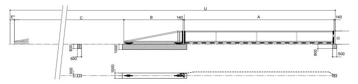
$<sup>\</sup>star$ E = 500 mm (ohne hintere Sicherheitsleiste); E = 150 mm (mit hinterer Sicherheitsleiste)
