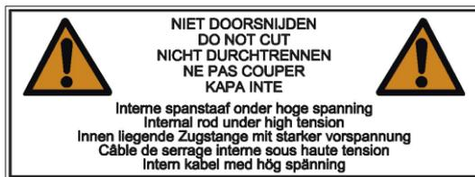
Abbildung 3: Warnaufkleber auf der unteren Träger
