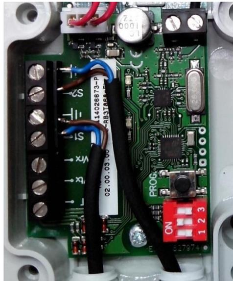
Abbildung 17: Beispiel Anschluss Sicherheitskontaktleisten an den JCM Sender RB3R686
