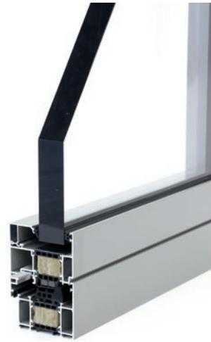
Die Konstruktion basiert zu 100 % auf einer Standard WICLINE 75 Grundkonstruktion und ist optisch von dieser nicht zu unterscheiden. Die selbstschließende, öffnbare Brandschutzverglasung ist ausführbar als Lochfenster, Fenster mit Umfeld oder integriert in die Pfosten-Riegel-Brandschutzfassade WICTEC 50FP.
