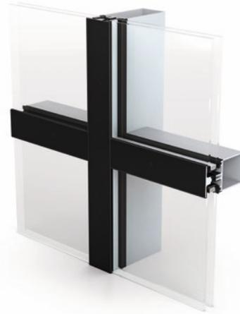
Maximale Transparenz durch minimierte Profilsichten: Mit seinen integrierten Andruckprofilen bietet das Design von WICTEC 50SG eine kostengünstige Variante mit einer SG-ähnlichen Fasadenästhetik. Beide Lösungen, die entweder mit einer mit dem Glas flächenbündigen oder alternativ sehr flach aufliegenden Andruckleiste erhältlich sind, sind eine schnelle und einfache Erweiterung einer klassischen Pfosten-Riegel-Fassade.
