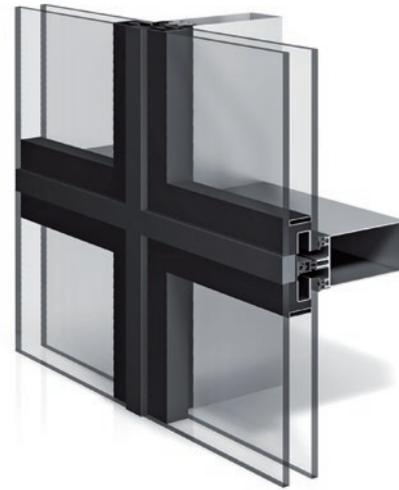
Charakteristisch für die Structural-Glazing-Fassade WICTEC 50SG ist die filigrane Optik mit schlanken Silikonfugen zwischen den einzelnen Verglasungselementen. Das System bietet Ganzglastechnik mit Isolierverglasung und kann sowohl in vertikalen Fassaden wie in Glasdächern eingesetzt werden. Auf Basis der WICTEC Pfosten-Riegel-Fassade können diese Varianten einfach und wirtschaftlich auf höchstem technischem Niveau erstellt werden.
