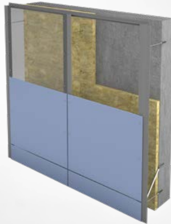
BETA Universal II für sichtbare Befestigung
