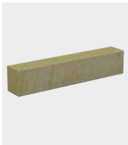
Lamellendämmplatte aus Mineralwolle Wärmedämmplatte aus Mineralwolle nach DIN EN 13162; Hohe Abreißfestigkeit durch senkrecht stehende Fasern
