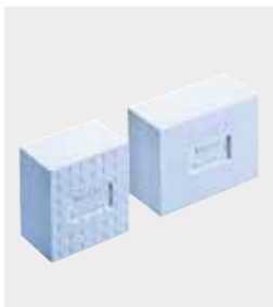
StoFix Quader ND Mini/Midi Montageunterlage zur Befestigung von leichten Lasten, z. B. Lampen, Regenfallrohren, Kleiderbügelträgern; Druckunterlage für mittelschwere Lasten
