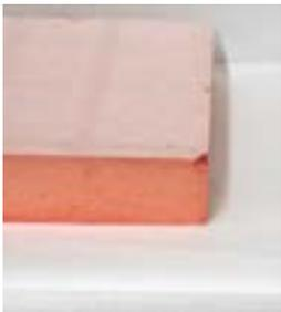
Phenolharzplatten sind empfindlich und müssen vor mechanischer Belastung (Druck, Sturz, Schlag) geschützt werden.
