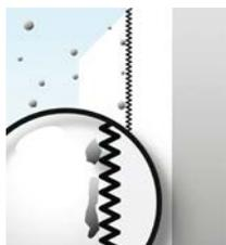
**Funktion 1:** Fassadenbeschichtungen mit Lotus-Effect® Technology haben eine mikrostrukturierte Oberfläche. Die Kontaktfläche für Schmutzpartikel und Wasser ist dadurch stark reduziert.
