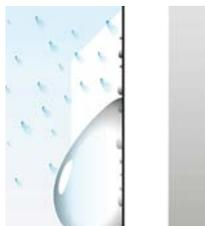
Die Oberfläche ist weniger hydrophob und deshalb stärker mit Wasser benetzbar. Schmutzpartikel können besser anhaften.
