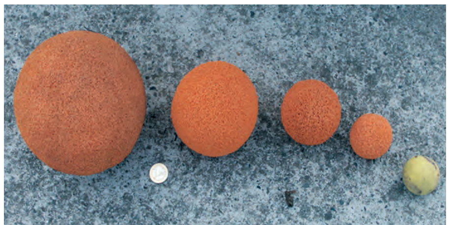
Reinigungsmolche verschiedener Größe [Quelle: Dipl.-Ing. M. Mäding]
