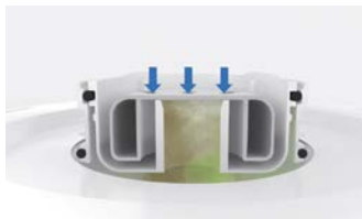
bei ausgetrocknetem Siphon mechanisch wirkende Geruchssperre
