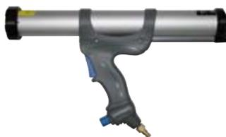
Druckluft-Pistole mit ergonomisch gestaltetem Pistolengriff. Alu-Zylinder für bis zu 620 ml Alu-Folienbeutel. Kartuschenverarbeitung nicht möglich.
