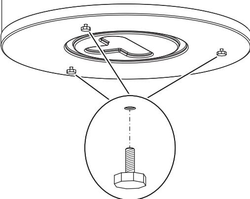
► Vyrovnejte prípadné nerovnosti terénu pomocou nastaviteľných nôh.
