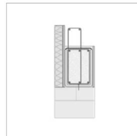
3. Rundstahlklammern zur Abspannung einsetzen, Schalung prüfen und ggf. weitere Sicherungsmaßnahmen durchführen und anschließend bis zum Deckenauf-lager betonieren.
