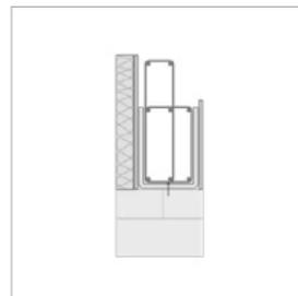
2. Bewehrungskorb und Armierungseisen unter Berücksichtigung der DIN EN 1992/NA einbauen.
