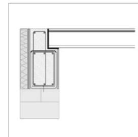
4. Spannbeton-Fertigdecke sicher verlegen und Ortbeton bis Oberkante Deckenrand in vorgeschriebener Güte und Konsistenz einbringen und verdichten.
