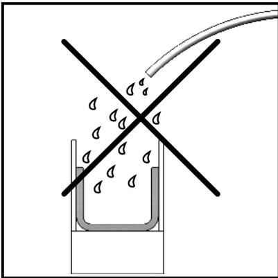
Die MAKO Schalungen **auf keinen Fall** wässern, um Trennlage zwischen Beton und Schalungsplatte zu vermeiden.
