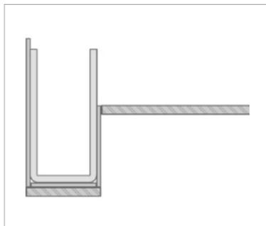
1. Schalungselemente dicht aneinander stoßen lassen, Mauerwerksöffnung überspannen und Schalung abstützen.
