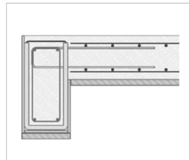
3. Rundstahlklammern zur oberen Abspannung einsetzen, Schalung prüfen und ggf. weitere Sicherungsmaßnahmen durchführen und anschließend betonieren.
