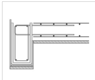
2. Bewehrungskorb unter Berücksichtigung der DIN EN 1992/NA einbauen und erforderliche Deckenarmierung einbinden
