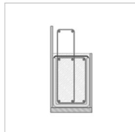
3. Rundstahlklammern zur Abspannung einsetzen, Schalung prüfen und ggf. weitere Sicherungsmaßnahmen durchführen und anschließend bis zum Deckenaufleger betonieren.
