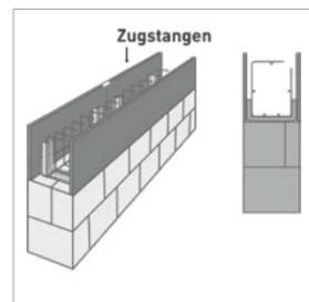
1. Schalungselemente auf dem Mauerwerk aufsetzen, dicht aneinander stoßen lassen und durch Elementausrichter auf dem Mauerwerk fixieren.
