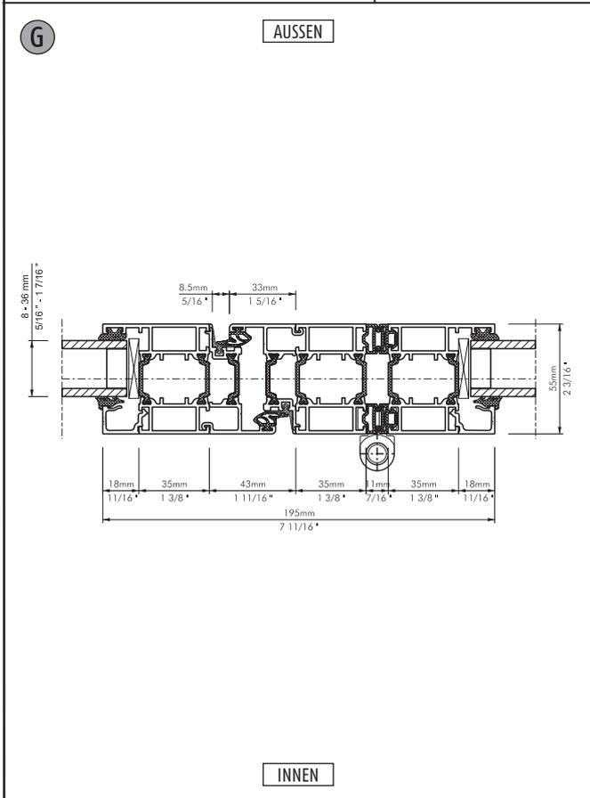
Bezeichnung: Horizontal-Schnitt, Profilschnitt mitlaufender Holm (z.B. 1L/2R) / innen faltend
