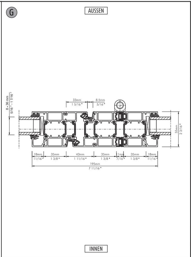
Bezeichnung: Horizontal-Schnitt, Profilschnitt mitlaufender Holm (z.B. 1L/2R) / aussen faltend
