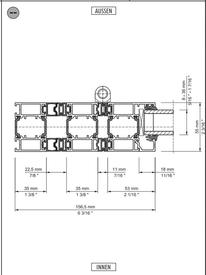
Bezeichnung: Horizontal-Schnitt, Flügel Profilschnitt inkl. mitl. Holm (z.B. 2R) / aussen faltend
