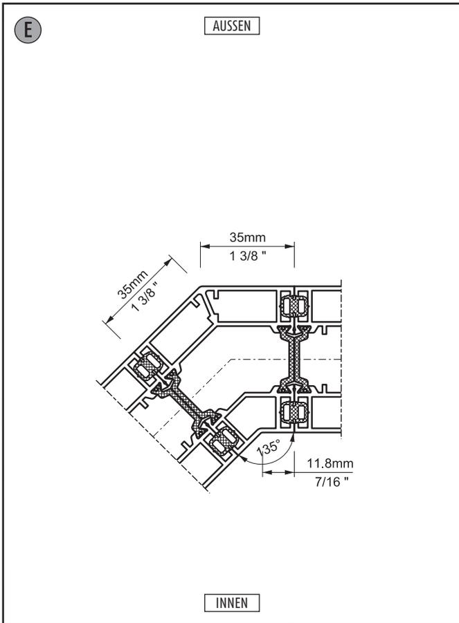
Bezeichnung: Horizontal-Schnitt, 135° Anschlussprofil
