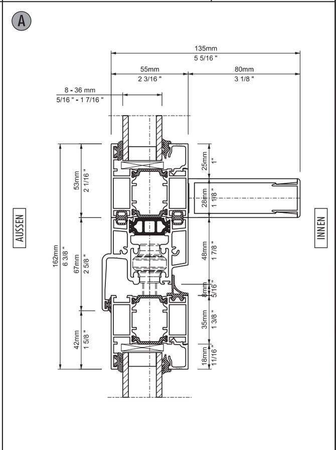
Bezeichnung: Vertikal-Schnitt, Verstärkungsprofil für Brüstung / innen faltend
