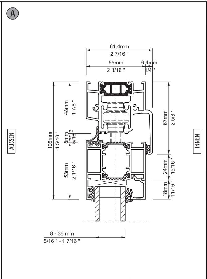
Bezeichnung: Vertikal-Schnitt, Anschluss Deckenschiene / innen faltend
