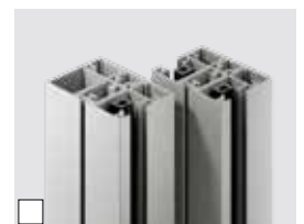
zipSCREEN.2 freistehende Führungsschiene 68 x 53 mm Empfohlen als freistehende Führungsschiene, z. B. vor einer Schiebetür, wenn keine Schienenbefestigung Richtung Fenster-Blendenrahmen möglich ist. Auch als Doppel-Führungsschiene 68 x 53 mm für Blendenrahmenmontage erhältlich.
