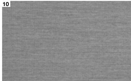
Abb. 10: Infinity Das PVC-freie Acrylgewebe bietet Blend- und Sichtschutz aber keinen Sichtkontakt nach außen (keine Brandschutzklasse). Schattenrisse vor allem bei hellen Geweben möglich.
