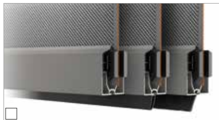
Optionaler „doppelter Fallstab“ in glatt, mit Bürste oder mit Dichtprofil (z. B. Reduktion von Licht- und Schmutzeinfall). Für schmale Anlagen, Doppelter Fallstab ragt ca. 25 bis 35 mm aus dem Kasten (siehe aktuelle technische Unterlagen)
