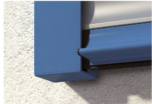
Unterer Verschluss bei Montage auf die Fassade; bei dieser Montageart 10 mm Abstand zur Fassade beachten
