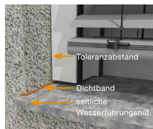
Nicht eingeputzte Führungsschiene mit Steinfensterbank
