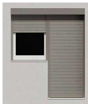
Blendenkombination bei unterschiedlicher Elementhöhe mit zwei Einzelführungsschienen in der Mitte; maximale Breite: 6000 mm (bei INTEGO maximale Breite: 4000 mm)
