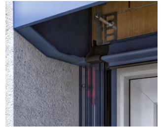
Kastenzusatzbefestigung bei Panzergewicht über 20 kg (Abb.XP-System)
