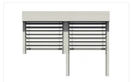
Blendenkombination bei unterschiedlicher Elementhöhe mit zwei Einzel-Führungsschienen in der Mitte
