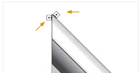
Bei schwerer Zugänglichkeit oder Montage auf die Laibung kommen Zusatzmontagewinkel zum Einsatz.
