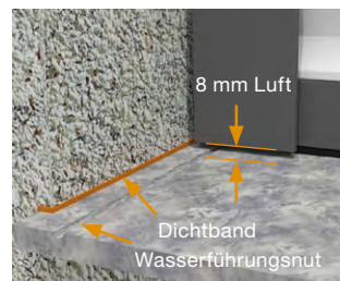
Nicht eingeputzte Führungsschiene mit Steinfensterbank
