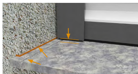
Nicht eingeputzte Führungsschiene mit Steinfensterbank
