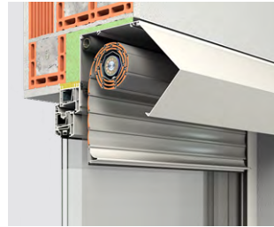
Revisionsmöglichkeit vorne am Beispiel QUADRO.XP
