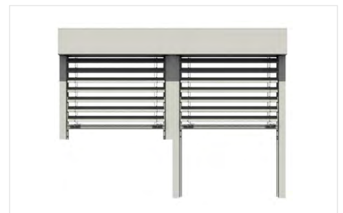
Blendenkombination bei unterschiedlicher Elementhöhe mit zwei Einzel-Führungsschienen in der Mitte
