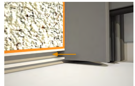
Führungsschiene mit ausgeklinktem Bordprofil und 8 mm Abstand zum Dehnungsausgleich
