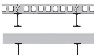
Decken mit im Zwischendeckenbereich freiliegenden Stahlträgern nach DIN EN 1993 mit einem  $A_P/V$ -Wert  $\leq 300 \text{ m}^{-1}$  und einer oberen Abdeckung nach DIN EN 206-1 / DIN 1045-2, DIN EN 1992-1-2 in Verbindung mit dem Nationalen Anhang NA in einer Mindestdicke von 50 mm aus Normalbeton oder Spannbeton.
