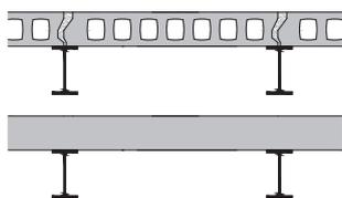
Decken mit im Zwischendeckenbereich freiliegenden Stahlträgern nach DIN EN 1993 mit einem  $A_P/V$ -Wert  $\leq 300 \text{ m}^{-1}$  und einer oberen Abdeckung nach DIN EN 206-1 / DIN 1045-2 oder DIN 4213 und DIN EN 1520, DIN EN 1992-1-2 in Verbindung mit dem Nationalen Anhang NA in einer Mindestdicke von 50 mm aus Leichtbeton oder Porenbeton
