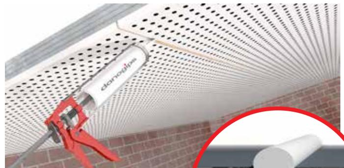
Um die Fuge vollständig zu füllen, muss so viel Spachtelmasse eingepresst werden, dass diese oberhalb der Fuge leicht austritt. Das Füllen mit einem Spachtel durch Eindringen in die Fuge ist nicht ratsam.
