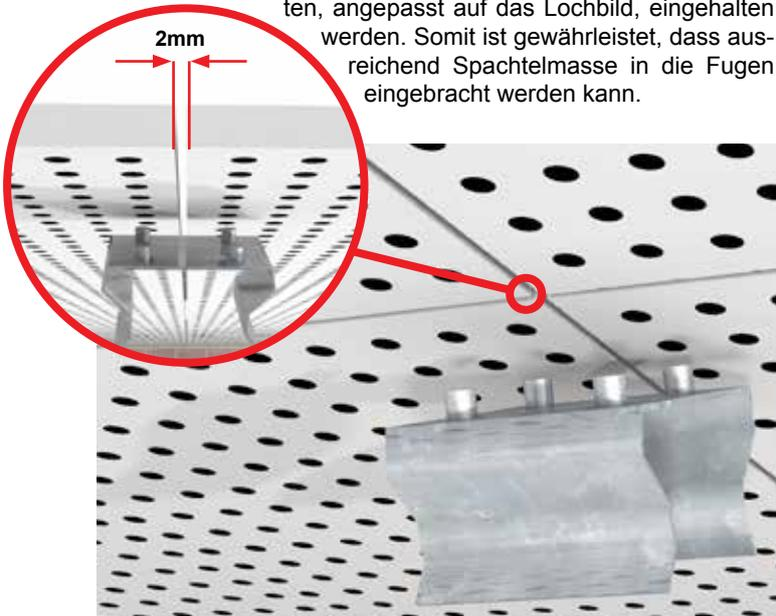
Für eine fachgerechte Fugenverspachtelung wird das Brechen der Plattenkanten mittels Schleifgitter empfohlen.
