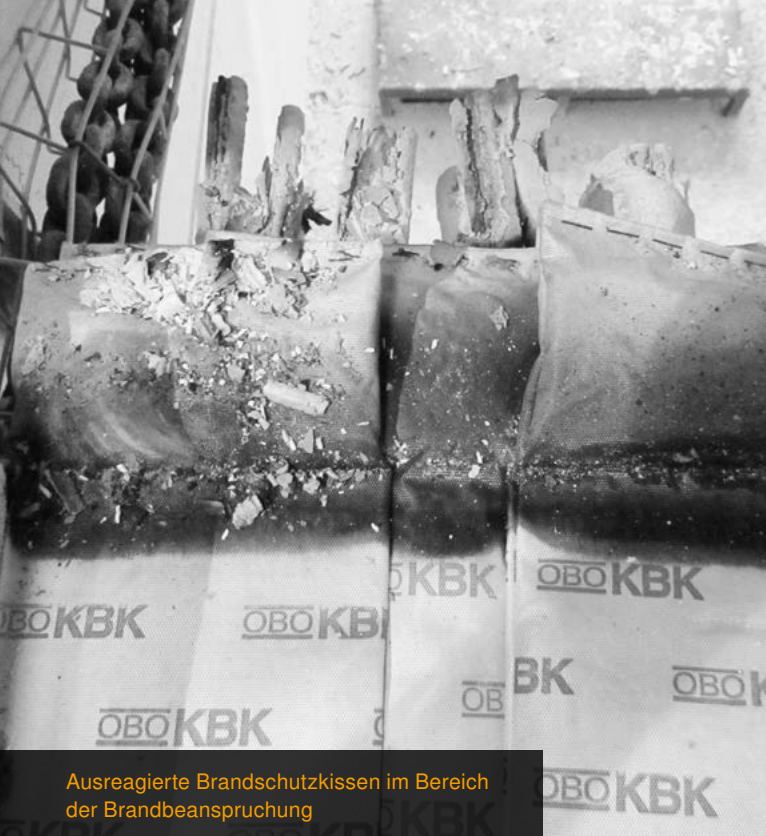
Simulation des Reaktionsverhaltens von Schottungsmaterial
