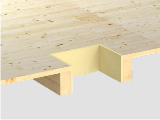
Holzbalkendecke ohne Unterdecke
