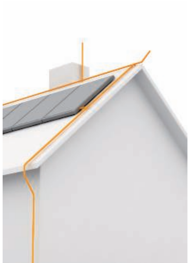
Direkter Anschluss der PV-Montagegestelle an die Blitzschutzableitung
