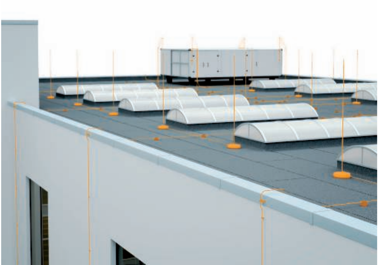
Natürliche Bestandteile (hier Attikablech) für Fangeinrichtungen, VDE 0185-305-3 (IEC 62305-3)
