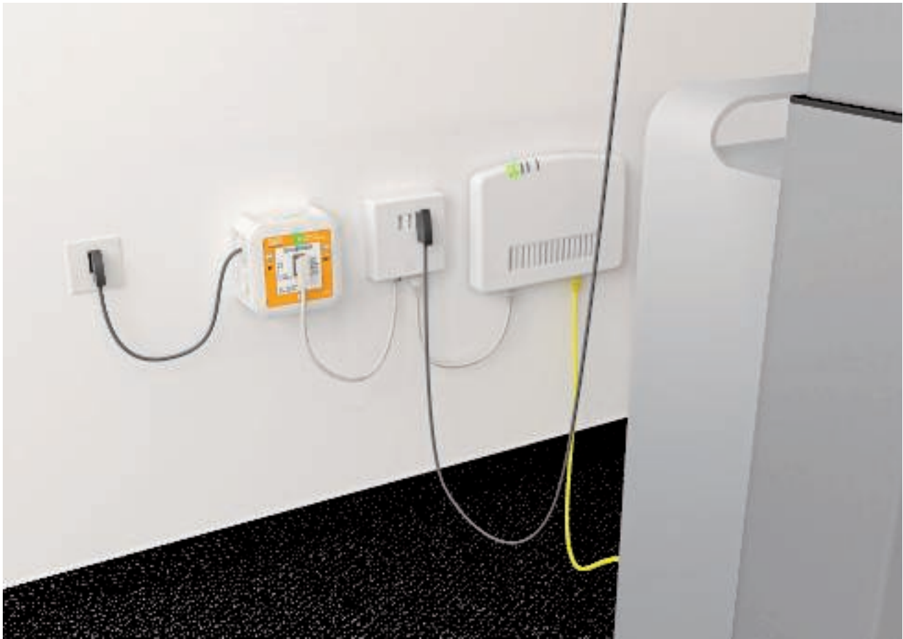
Schutz eines ISDN- + DSL-Anschlusses mittels TeleDefender
