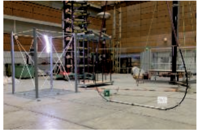
Prüfaufbau während einer Stoßspannungsprüfung mit einem äquivalenten Trennungsabstand ( s_e ) von 75 cm.
