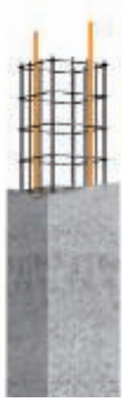
Beispiel: Nutzung von bewehrten Betonstützen/Ableitungseinrichtung
