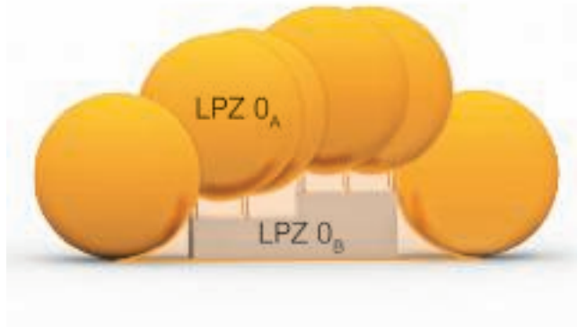
Blitzkugelverfahren und resultierende Blitzschutzzonen (LPZ)
