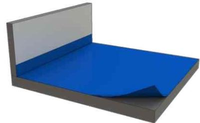
**3)** (Optional) Verlegung einer geeigneten Dampfsperre. Dies bewirkt, dass keine Feuchtigkeit aus der Rohdecke in den Fußbodenaufbau gelangt.
