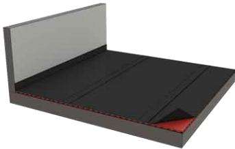
**7)** (Optional) PE-Folie (0,2 mm) auslegen, an den Stößen ca. 20 cm überlappen. Die Folie an allen Wänden und anderen aufgehenden Bauteilen ca. 15-20 cm über Oberkante des Fertigfußbodens ziehen.
