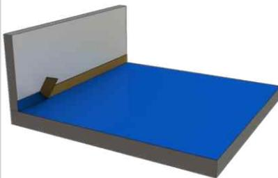
**4)** An allen Wänden und anderen aufgehenden Bauteilen Randdämmstreifen anbringen.
