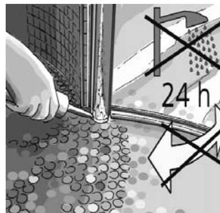
Fuge zwischen Wandanschlussprofilen und Fliesen vertikal und horizontal mittels beiliegender Silikontube abdichten. Für mindestens 24 Stunden keine Bewegung und Wasserbelastung vornehmen.
