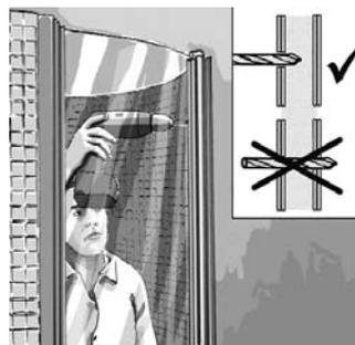
Nicht durch gesamten Profilquerschnitt vorbohren! Anschlagholm auf gegenüberliegender Seite in Abhängigkeit der Fliesengröße justieren und analog Anschlagseite befestigen.
