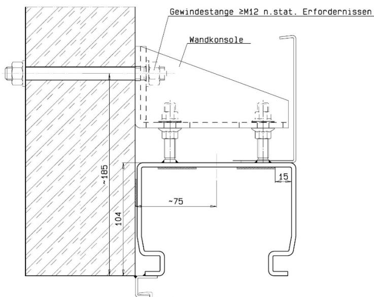
**Achtung: Laufschiene nur soweit montieren, dass das breiteste gelieferte Panel noch problemlos in die bereits montierte Schiene(n) eingeschoben/eingehängt werden kann**
