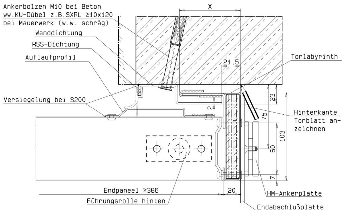
4.8.3 Torblatt komplett schließen und an Hinterkante lotrecht ausrichten.
