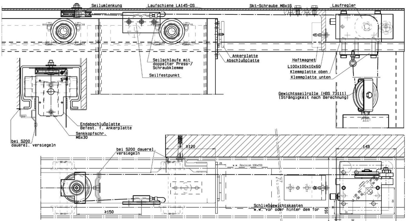
4.14.2 Bei Feststellanlage: Ankerplatte für Haftmagnet an der Abschlußplatte des Endpanels verschrauben.
