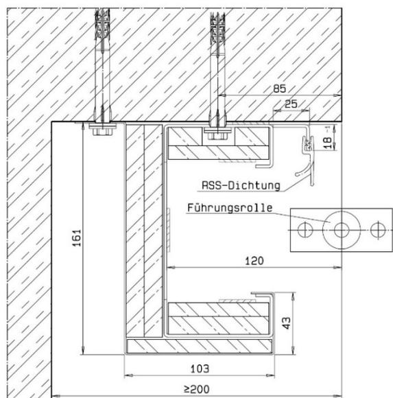
4.1.4 Rauchschutzdichtung aufstecken, Länge von OFF bis Sturz. Erst endgültig anpassen, wenn alle erforderlichen Dichtungen 3 oder 4seitig aufgesteckt sind.
