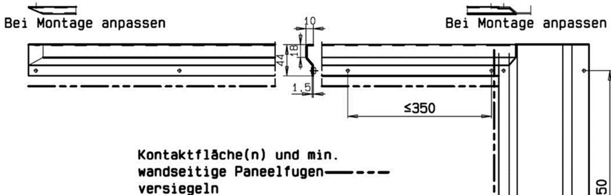
Schiebetore mit Ausführung **Sa** (dicht schließend) müssen **IMMER** dreiseitig (2x senkrecht + sturzseitig mit Rauchschutzdichtungen Typ "System Schröders RSS" ausgestattet werden. Die Auflaufprofile (sturzseitig + hinteres Labyrinth) müssen vor/beim Befestigen, dauerelastisch (Achtung Silikon ist NICHT überstreichbar) versiegelt werden.
