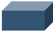
Zweifaches Dünnformat 2DF 240×115×113 mm
