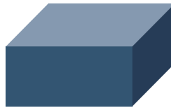
Dreifaches Dünnformat 3DF 240×175×113 mm
