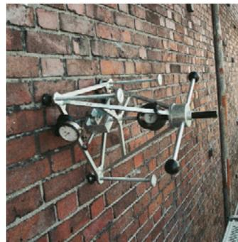
Mittels Belastungsprüfungen werden stichprobenartig Anker auf Zugbeanspruchung geprüft.
