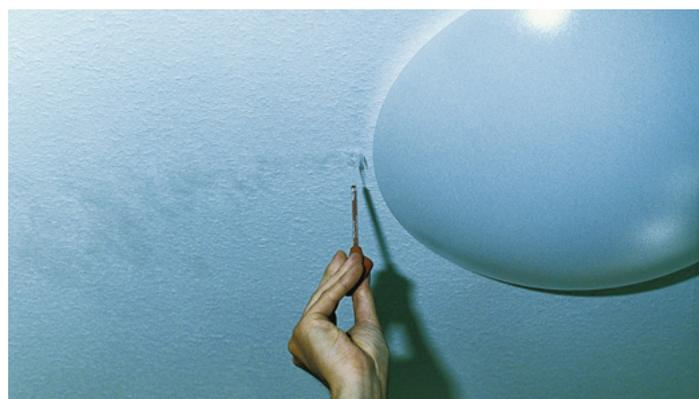
Foto 8: Kontrollmessung nach Bezug des Gebäudes. Massive Zuglufterscheinungen im Bereich von Deckenlampen
