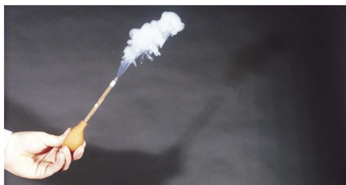
Foto 5: Aufgesägtes Glasröhrchen; durch Drücken auf den Gummiball wird Rauch freigesetzt.
