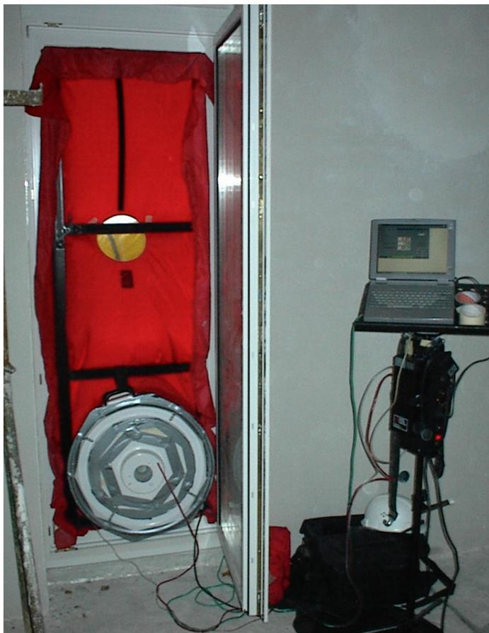
Blowerdoortest zur Prüfung der Gebäudedichtheit an der Terrassentür
