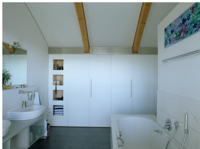
Badezimmer mit Gitter der kontrollierten Lüftungsanlage in der Rückwand
