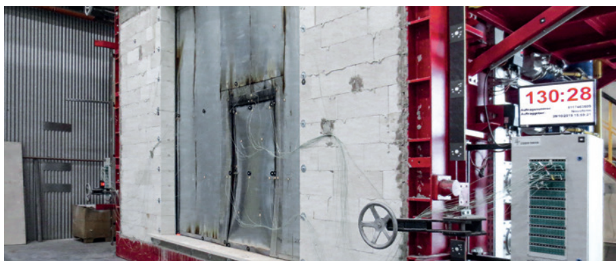
Brandprüfung Toransicht nach 130 Minuten
