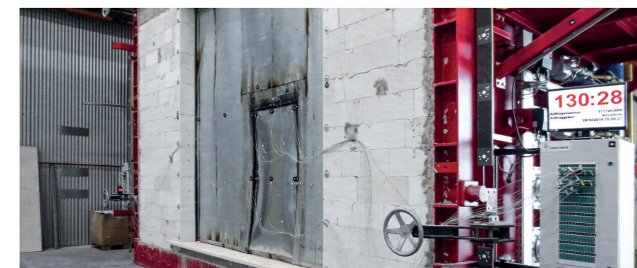
Brandprüfung Toransicht nach 130 Minuten
