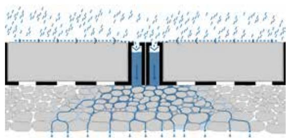
Der patentierte Doppelrahmen nimmt den einwirkenden Druck vom Schmutz. Damit kann sich die Drainage nicht zusetzen und verdichten. Im Winter versickert das Tauwasser und kann keine Glätte bilden!
