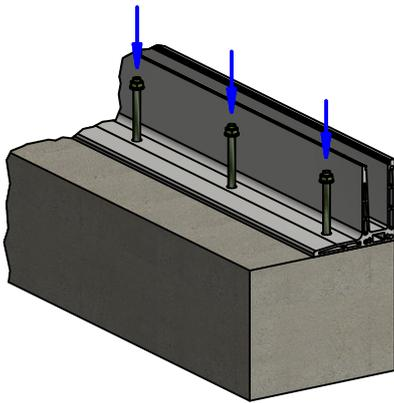
1. Basisprofil am Baukörper befestigen
