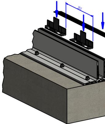
2. Anlagegummi anbringen und Glasmontagesystem (Abstand 250 mm) einlegen\*
