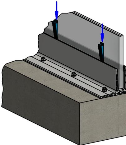
4. Montagekeile (blau) zur Stabilisierung der VSG Glasscheibe einlegen
