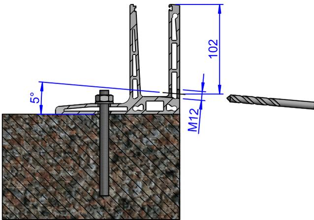
1. Bohren und Gewindeschneiden auf Bohrachse 102 mm ab Oberkante nach unten 5° Neigung beachten
