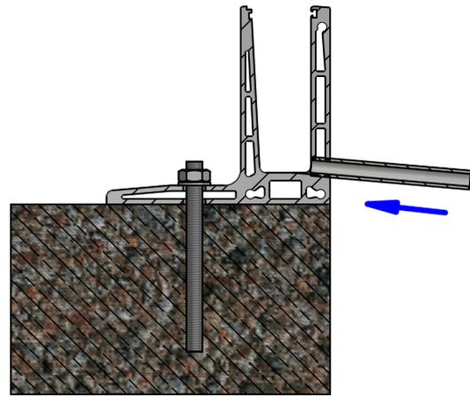
2. Einbringung des Röhrchens mit Kleber auf das Gewinde
